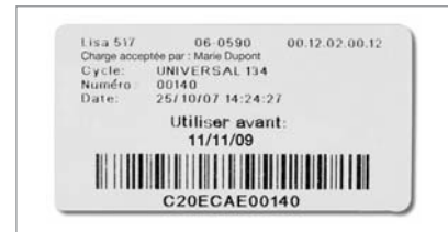
▲ Abb. 3: Das Etikett gibt Aufschluss über den Benutzer, der das Sterilgut freigegeben hat, die Nummer des Sterilisators, die Chargennummer, das Datum der Sterilisation und die Lagerfrist des Sterilguts.
