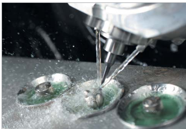
▲ Die Bearbeitungseinheit Everest engine mit 5-Achsen-Technologie. ▲ Das Everest CAD/CAM-System von KaVo.
