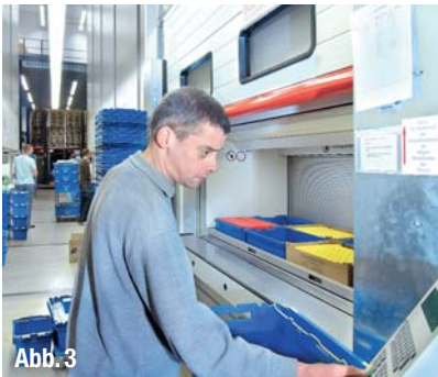
▲ Abb. 3: Der NWD-Mitarbeiter schließt das Tor der Kühlzelle. Bei Entnahme von gekühlten Medikamenten schützt das zweite Tor die Kühlzelle vor Temperaturschwankungen.
