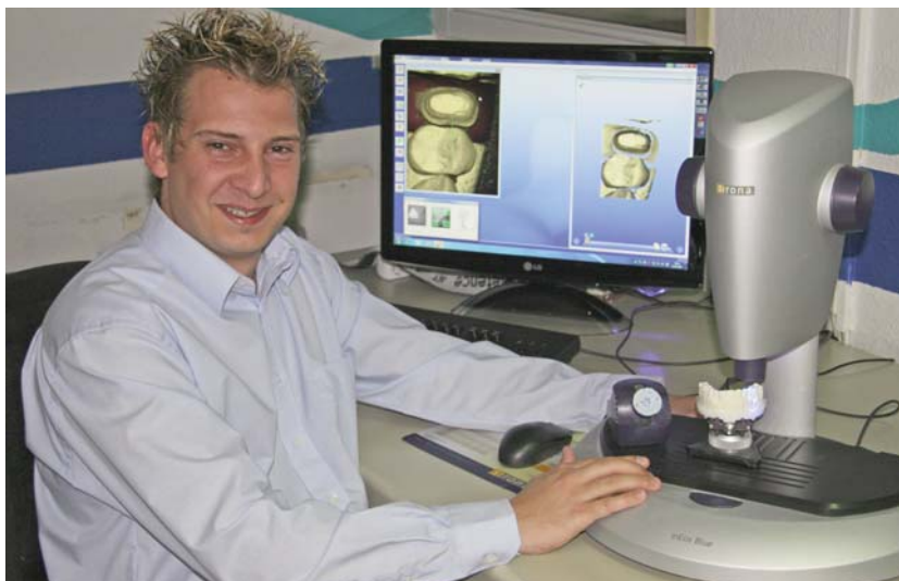
▲ Zahntechniker Patrick Keim beim Scannen eines Modells mit inEos Blue.
