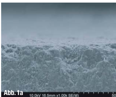
▲ Abb. 1a–1c: Vergleich der Abrasion von Fuji IX GP Extra (entsprechend EQUIA Fil) mit und ohne G-Coat Plus (entsprechend EQUIA Coat) nach 20.000 Zyklen (Quelle: Kato K, Yarimizu H, Nakaseko H, Sakuma T: Influence of coating materials on conventional glass-ionomer cement. Abstract 487. IADR 2008, Toronto, Canada). ▲ Abb. 1a: Ohne Coating. ▲ Abb. 1b: Mit G-Coat Plus. ▲ Abb. 1c: Mit Biscover LV.
