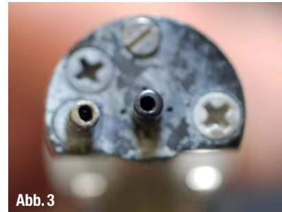
▲ Abb. 3: Biofilm und Kalkablagerungen an der Luft-Wasser-Spritze.
