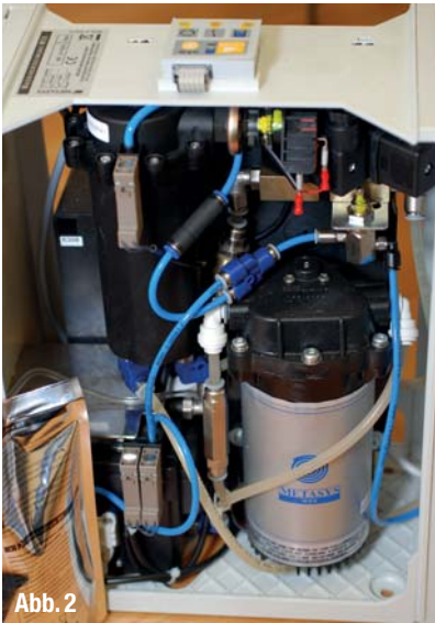
▲ Abb. 2: Freier Auslauf gemäß DIN EN 1717.
