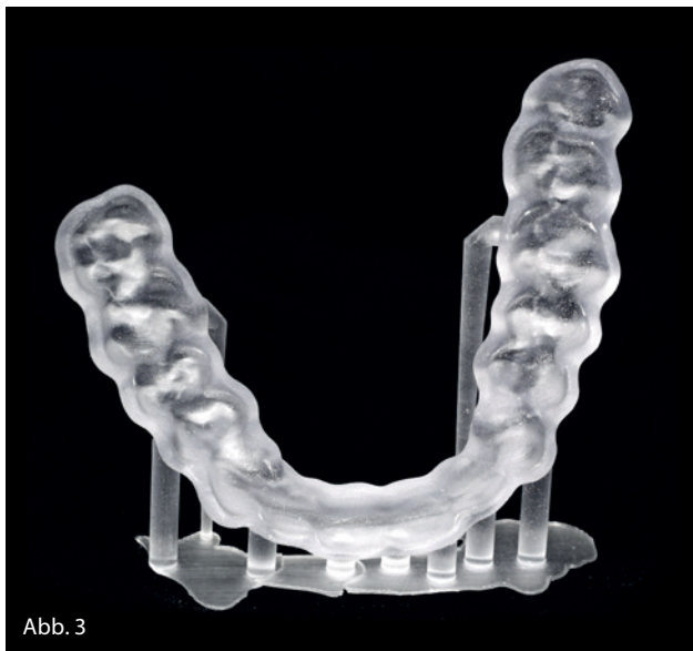
Abb. 3: Gereinigte Schiene auf Trägerplatte. Abb. 4: Ausgearbeitete und hochglanzpolierte Schiene.
