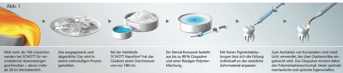
Abb. 1: So kommt das Glas in den Zahn: Vom Rohmaterial zur Kompositfüllung.
