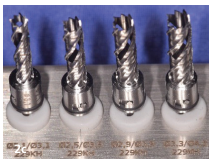
Abb. 2a: Das Trepan Kit. – Abb. 2b: Vier Vortrepane mit unterschiedlichen Durchmessern. – Abb. 2c: Vier Trepane mit unterschiedlichen Durchmessern. – Abb. 2d: Zweiteiliger Trepanbohrer. – Abb. 2e: Die Karotte kann problemlos nach Entfernung des koronalen Teils des Trepanns entnommen werden.
