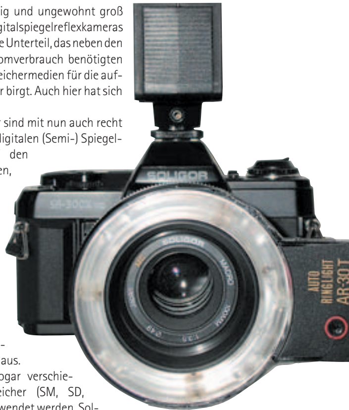
Vertreter einer analogen Kamera für die zahnärztliche Fotografie mit Ringblitz: SOLIGOR Analog.
