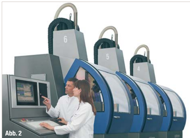
Abb. 2_ Zur Bearbeitung von ZrO_2 -Keramik für Kronen- und Brückengerüste verfügen Fräszentren über eine ausgeklügelte Qualitätssicherung. (Foto: etkon-Straumann)
