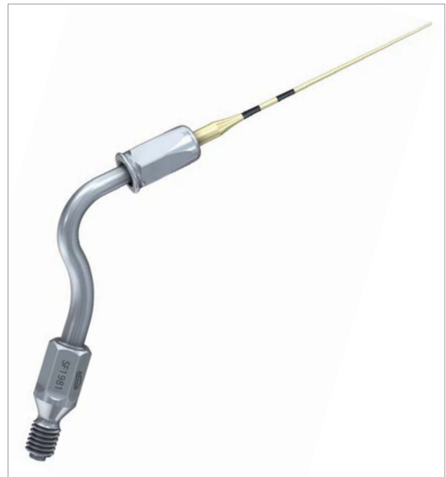
Abb. 2: SF65 – Durch die schallaktivierte Bewegung und Mikroströmungen wird die Wirksamkeit der Spüllösung erhöht.
