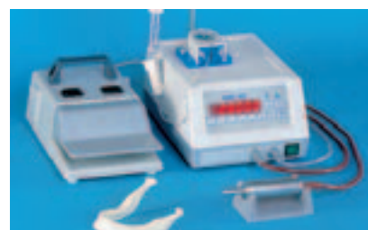
MD 10 No. 2010 Einfachmotorsystem frequenzgesteuert, bürstenloser Mikromotor, OP-Zulassung mit Pedal IP 68, regulierbar von 500–40.000 U/min
