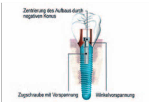
Abb. 1: Die Querschnittszeichnung verdeutlicht, dass das BPI-Easy-Fit-Implantat nicht nur anatomisch ästhetisch gestaltet ist, sondern die Abutmentbefestigung technisch neu gelöst ist.
