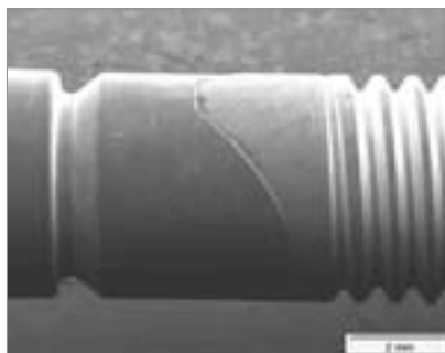
Abb. 2: Die rasterelektronische Aufnahme verdeutlicht den Aufpresseffekt des Abutments auf die Dachform des Implantatkörpers, der in seiner ganzen Breite als externer Verdrehungsschutz wirkt. – Abb. 3: Die kritische Zone – das Plateau der Dachform – weist rasterelektronenmikroskopisch nur einen minimalen Spalt auf. – Abb. 4: Die gelbe Linie verdeutlicht die vorhandene Kauebene. Anhand der CT-Navigationsplanung zeigt sich der extreme Insertionswinkel des Implantates Regio 11.
