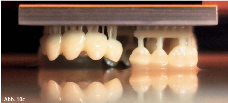
Abb. 10a und b: 3-D-gedrucktes Meistermodell mit Bohrschablone. – Abb. 10c: 3-D-Druck von temporären Versorgung A2 und A3.
