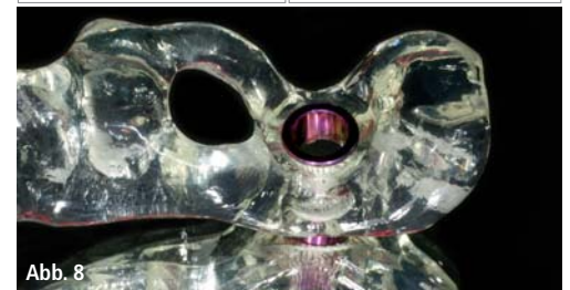
Abb. 7a: SLA-Druckverfahren. – Abb. 7b: 3-D-Drucker DWS 028D. – Abb. 8: DWS 028D-3-D-Druck einer Bohrschablone.
