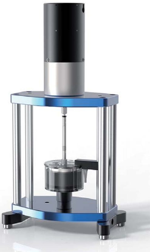
Abb. 4: Einzelprüfanlage mit beheiztem Prüfbecken.
