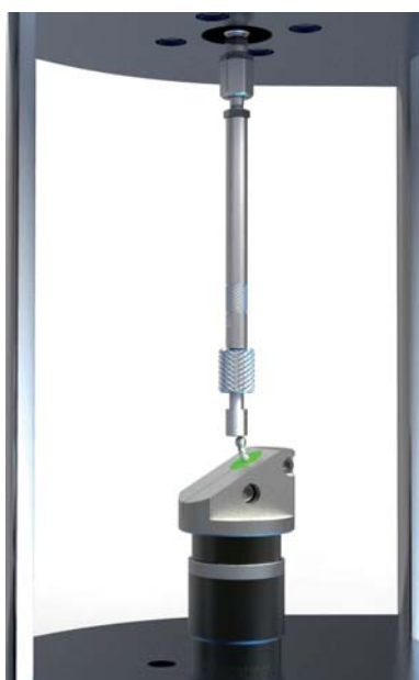
Abb. 2: Prüfraum mit unten angeordnetem Kraftsensor, Probenhalter und beweglichem Stößel.
