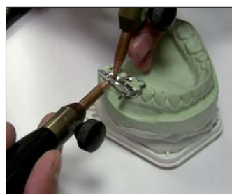
Abb. 21: Entfernen des Vorschubstegs, anschließendes Löten oder Lasern.
