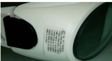
Abb. 27: Kennzeichnung der Schutzbrille: Schutzstufe, Wellenlänge, Betriebsart.
