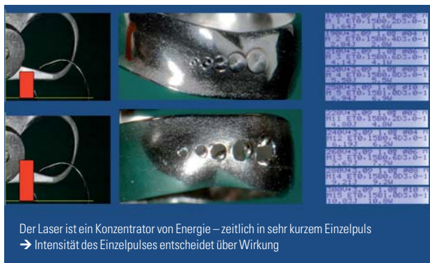
Abb. 31: Drittes Experiment: Laserstrahlung auf Metallband mit Einzelpulsen.
