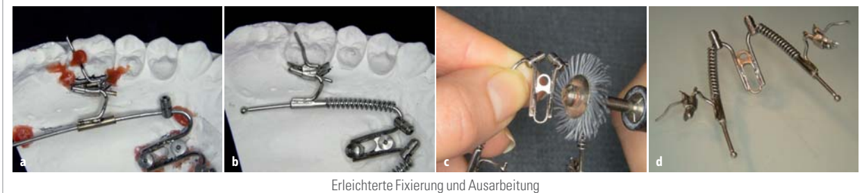
Abb. 5a-d: Rationelle Vor- und Nachbereitung dank Lasertechnik. Präzise und kontrollierte Herstellung komplexer Metallapparaturen.
