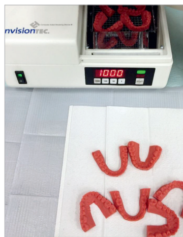
Abb. 5: Entfernen der gedruckten Zahnkränze von der Aufbauplattform durch einen Labortechniker. – Abb. 6: Auf einem EnvisionTEC Perfactory Vida wurden diese Zahnkränze aus Ortho Tough, einem haltbaren Dentalwerkstoff, gedruckt und gehärtet. (Abb. 2 bis 6: Mit freundlicher Genehmigung der EnvisionTEC GmbH Gladbeck)
