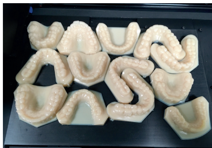
Abb. 6: Ungereinigte Modelle nach dem Druck.
