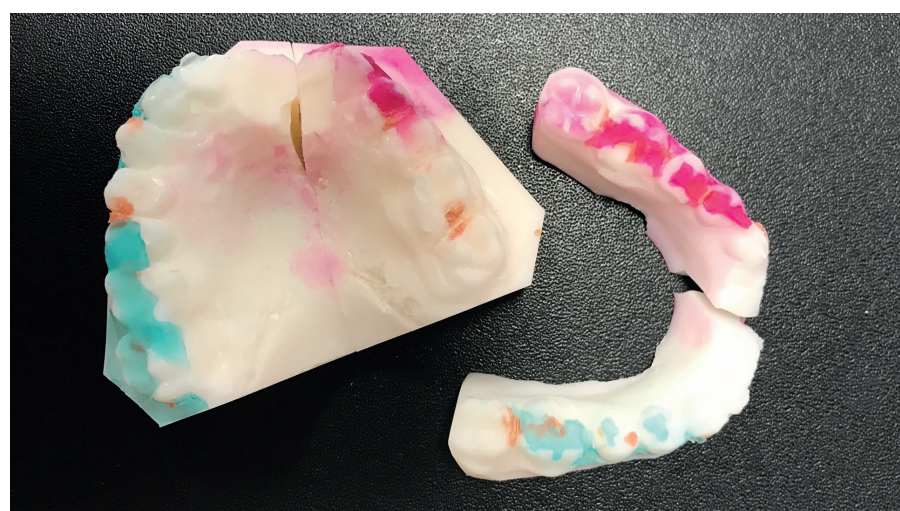
Abb. 9: Modellbruch bei Streuen auf nicht isoliertem Modell.
