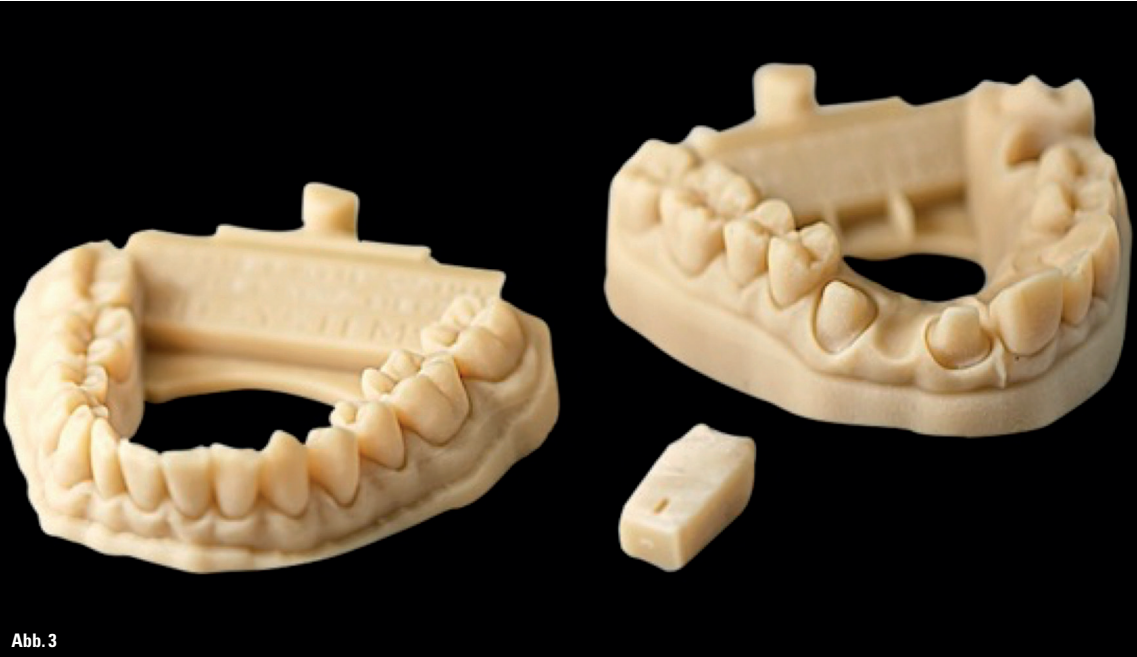
Abb. 3: Stumpfmmodelle aus einem ProJet/MJP-Drucker ohne Nachhärtung. Direkt nach Wachsupport-Entfernung. (Quelle: https://www.3dsystems.com/dental ) – Abb. 4: Kombination aus 3D-Metalldruck und Frästechnik. Steckbare Stegarbeit mit Nacharbeit in einer Dentalfräsmaschine, um die gewünschte Passung und Oberflächengüte sicherzustellen. (Quelle: 3dsystems)
