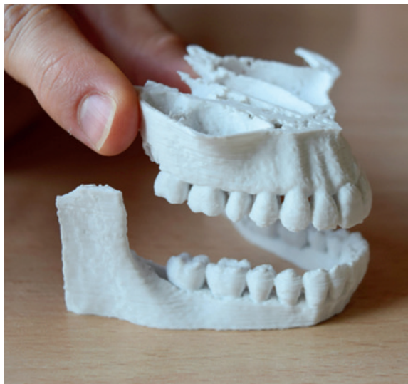
Abb. 1: FDM-gedrucktes Chirurgieplanungsmodell mit sehr deutlicher Rillenbildung nach der Produktion. (Quelle: https://vexmatech.com/Indien/ )
