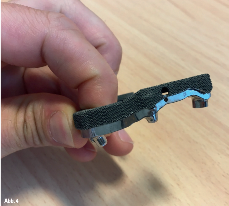
Abb. 3: Stumpfmmodelle aus einem ProJet/MJP-Drucker ohne Nachhärtung. Direkt nach Wachsupport-Entfernung. (Quelle: https://www.3dsystems.com/dental ) – Abb. 4: Kombination aus 3D-Metalldruck und Frästechnik. Steckbare Stegarbeit mit Nacharbeit in einer Dentalfräsmaschine, um die gewünschte Passung und Oberflächengüte sicherzustellen. (Quelle: 3dsystems)
