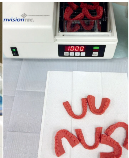
Abb. 5: Entfernen der gedruckten Zahnkränze von der Aufbauplattform durch einen Labortechniker. – Abb. 6: Auf einem EnvisionTEC Perfactory Vida wurden diese Zahnkränze aus Ortho Tough, einem haltbaren Dentalwerkstoff, gedruckt und gehärtet. (Abb. 2 bis 6: Mit freundlicher Genehmigung der EnvisionTEC GmbH Gladbeck)
