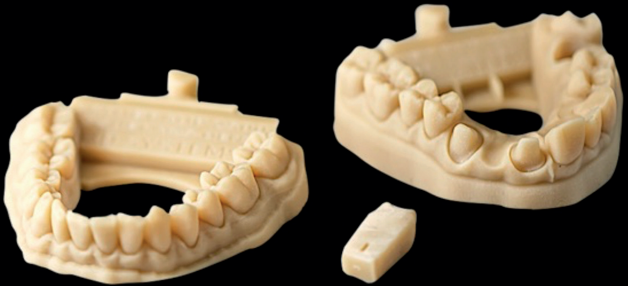
Abb. 3: Stumpfmodelle aus einem Projekt/ MJP-Drucker ohne Nachhärtung. Direkt nach Wachssupport-Entfernung. (Quelle: https://www.3dsystems.com/dental )
