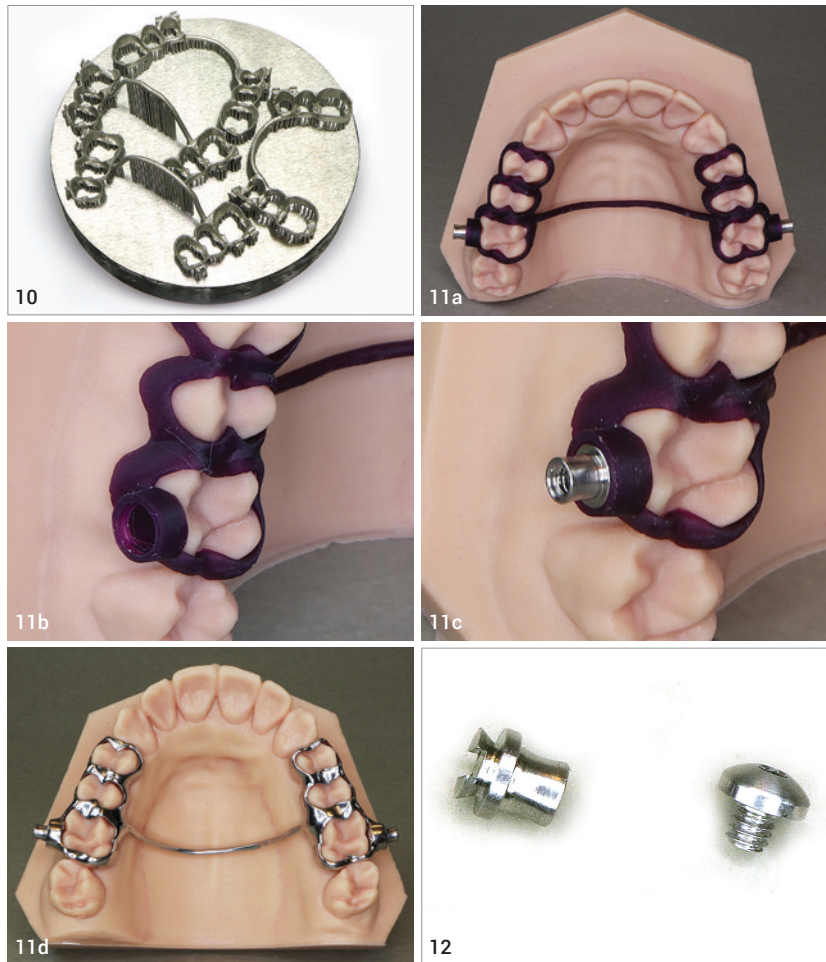
Abb. 10: Metalldruck der Apparatur im Laser-Melting-Verfahren. Abb. 11a: 3D-Druck des Kunststoffgerüsts mit aufgesteckten Hülsen zum Anguss. Abb. 11b: Detailansicht der gedruckten Modellgusschiene mit Retention zum Aufstecken der Gewindehülse. Abb. 11c: Detailansicht der gedruckten Modellgusschiene mit aufgesteckter Gewindehülse. Abb. 11d: Gegossener 3D-Druck der Modellgusschiene mit Hülsen (Castable-Wax-Resin-Verfahren). Abb. 12: Gewindehülse mit Schraube zur Befestigung des Scharniers an den Modellgusschienen.
