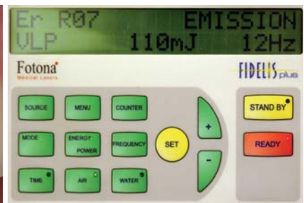
Abb. 1: Unbefriedigende Frontzahnkosmetik mit Kopfbissverzahnung nach kieferorthopädischer Progeniebehandlung. – Abb. 2: Frontzahnsituation nach Infiltrationsanästhesie und Applikation von Retraktionsfäden. – Abb. 3: Powersettings für blutungsfreie Gingivakorrekturen mit dem Er:YAG-Laser.
