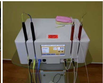
Abb. 1: OpusDuo Er:YAG- und CO 2 -Laser: 2.940 nm und 10.600 nm für Weichteilchirurgie/ Zahnschmerzabtrag. – Abb. 2: Hager & Werken Laser und HF: 975 nm und 660 nm und HF 2,2 MHz. Anwendungsbereiche: Endodontie, Parodontologie, Aphthen, Herpes, LLLT, aPDT.
