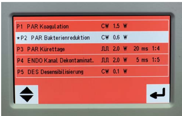
Abb. 5: Touchscreen-Display bietet übersichtliche Vorauswahl für verschiedene Indikationsbereiche des Diodenlasers. – Abb. 6: Im Untermenü des Gerätes kann nach Programmvorauswahl individuelle Einstellung von Behandlungsparametern erfolgen.
