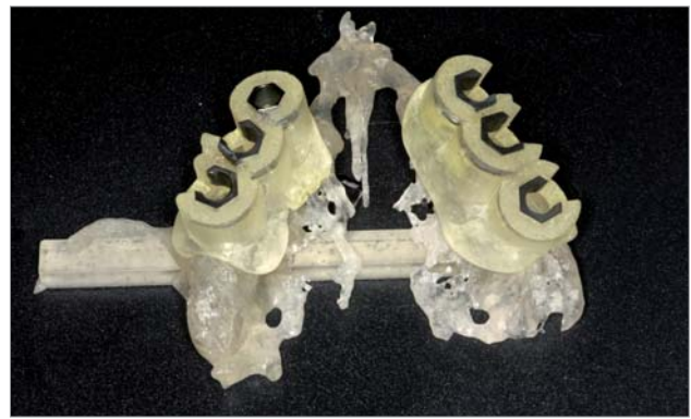
Abb. 4: Stereolithografisches Modell mit den geteilten Bohrschablonen.
