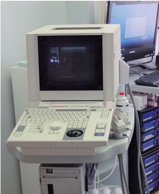
Abb. 9: Portables B-Scan-Gerät (Fa. Kranzbühler, Deutschland); das Gerät kann aufgrund seines geringen Gewichtes (7,5 kg) und der für ein B-Scan-Gerät geringen Ausmaße von Behandlungszimmer zu Behandlungszimmer mitgenommen werden. – Abb. 10: 7,5-MHz-Linear-Transducer und 3,5-MHz-Sektor-Transducer, wie sie für unser Fachgebiet typisch sind. – Abb. 11: B-Scan-Diagnostik; hier: Platzierung des Linear-Schallkopfes.
