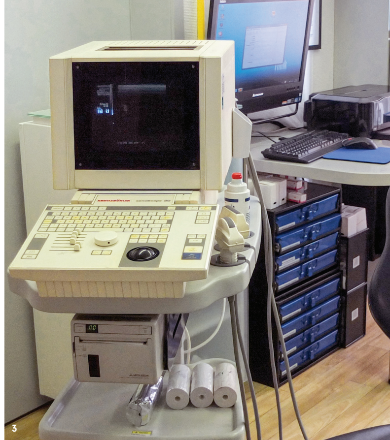
Abb. 3: Portables B-Scan-Gerät (Kranzbühler), das Gerät kann aufgrund seines geringen Gewichts (7,5kg) und der für ein B-Scan-Gerät geringen Ausmaße von Behandlungszimmer zu Behandlungszimmer mitgenommen werden.
