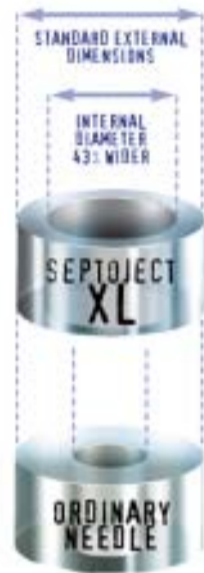
Abb. 3: Innendurchmesservergleich von XL und Standardnadeln.
