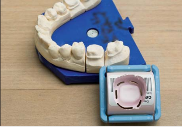
Abb. 12: ... von einer computergesteuerten Maschine herausgefräst.
