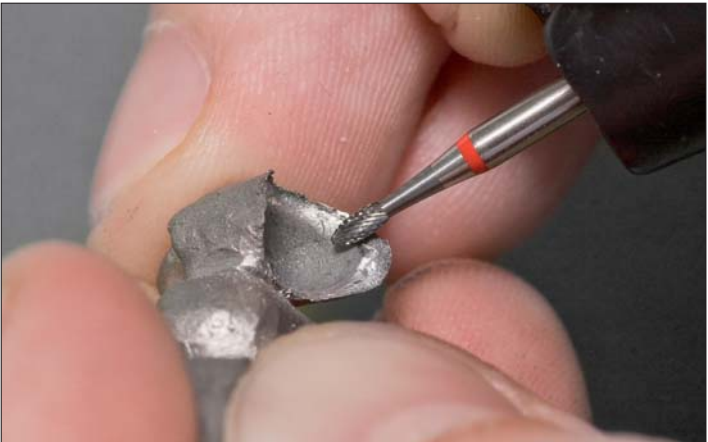
Abb. 23: Überstehende Fährchen werden mit einem Hartmetall-Ei entfernt.
