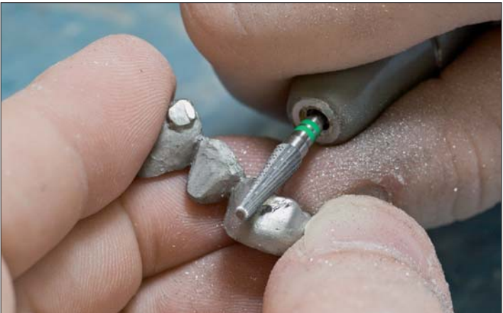
Abb. 20: Ein aggressiver Fräser mit hoher Initialschärfe, wie NE-Fräser von KOMET/GEBR. BRASSELER, tragen selbst hartes Material zügig ab.
