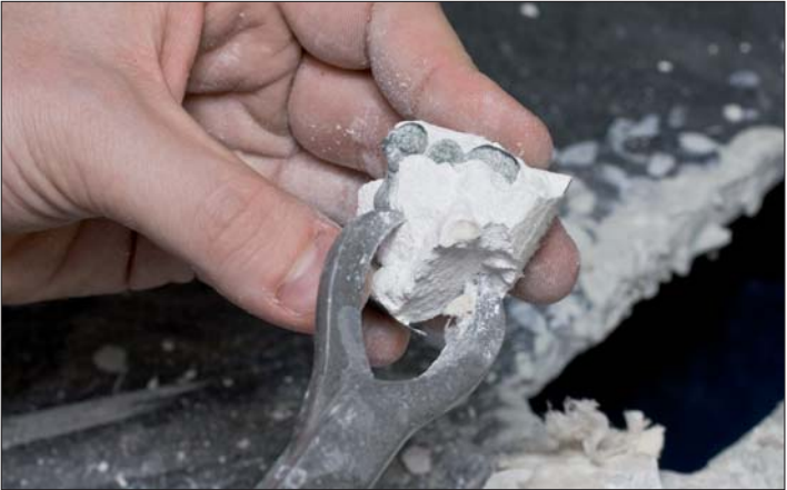
Abb. 16: Mit einer Zange wird die Einbettmasse vom Gussobjekt entfernt.
