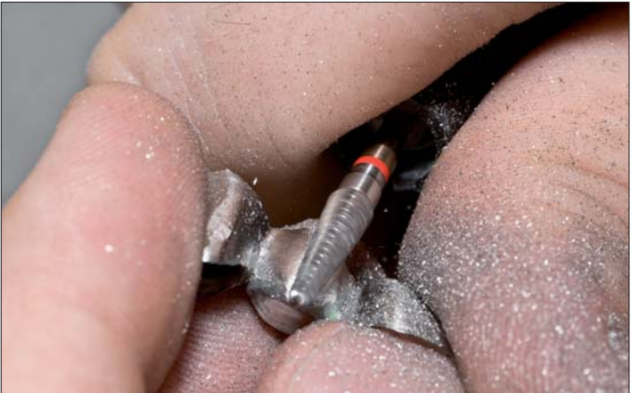
Abb. 26: Die Verblendflächen werden mit einem fein verzahnten UM-Fräser ausgearbeitet.
