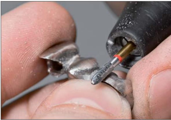
Abb. 27: Für den Rand verwendet man einen feinen Torpedofräser ...
