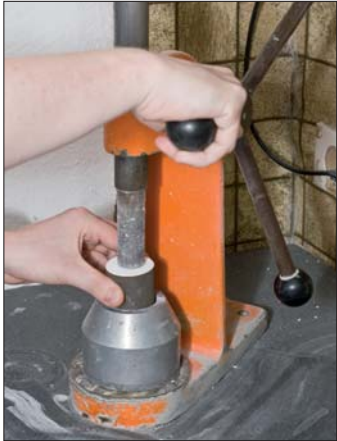
Abb. 14: Wenn die Muffel handwarm ist, kann sie mit Handdruck ausgebettet ...
