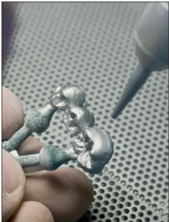
Abb. 18: Glanzperlen in 50 µm verleihen einen ersten feineren Schimmer. Bei EMF-Legierungen verzichtet man meist darauf, die Gusskanäle abzustrahlen.
