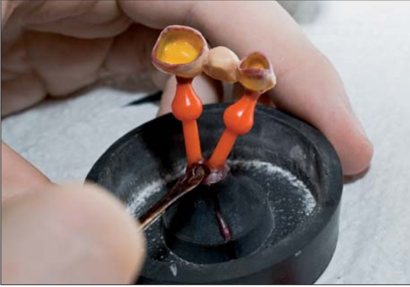
Abb. 6: Die abgehobene Wachsbrücke wird auf einem Sockelträger mit Trichterform festgewachst.
