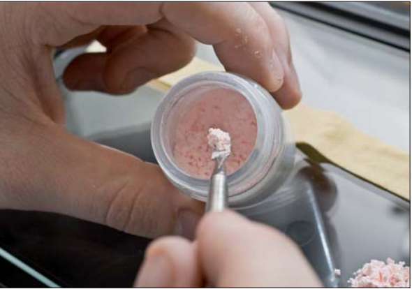
Abb. 7: Die pulverförmige Keramikmasse wird mit einem Spatel auf eine Glas- oder Mischplatte portioniert ...
