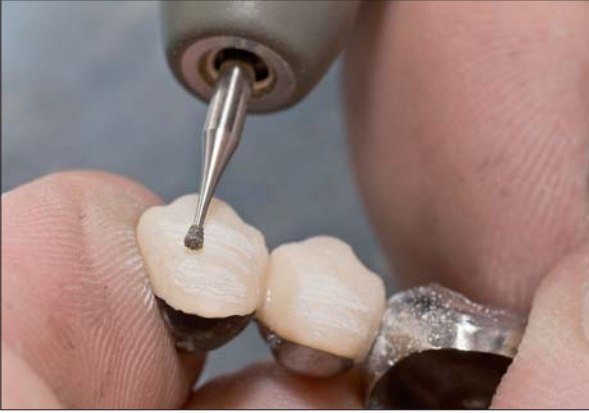
Abb. 22: Wachstumsrillen werden mit einem umgekehrten Kegel in die Vestibulärfläche geschliffen.
