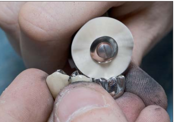
Abb. 28: Auf Hochglanz polieren kann man sehr gut mit einer Lederschwabbel ...
