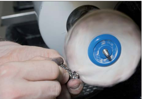
Abb. 29: ... oder einer Nesselschwabbel und Hochglanzpolierpaste am Polierautomaten.
