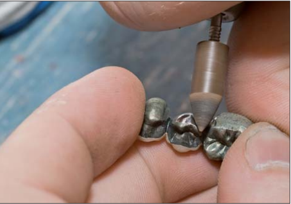
Abb. 25: Nach dem Glanzbrand werden die Metallflächen mit Gummierer ...
