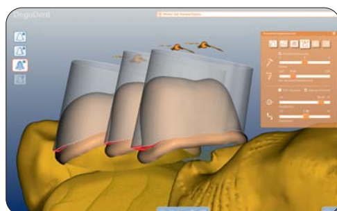
Design von Konuskronen am Bildschirm: Mit drei Schieberegler werden die Parameter festgelegt.
