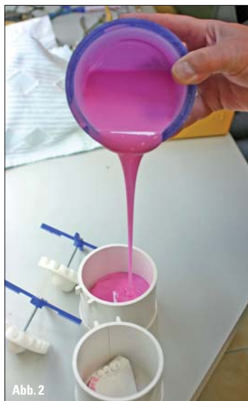
Abb. 1: Anzeichnen des prothetischen Äquators (Modellgussverfahren). – Abb. 2: Herstellung der Dublierform aus Silikon. – Abb. 3: Silikonform, Anfangsmodelle, Einbettmassemodelle (gelb). – Abb. 4: Wachmodellation mit Gewinde Regio 26. – Abb. 5: Fertige Wachmodellation in beiden Kiefern, angestiftet. – Abb. 6: Oberkieferguss, abgestrahlt. – Abb. 7: Aufgepasster Modellguss OK/UK.
