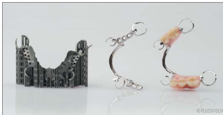
Herausnehmbarer Zahnersatz per digitaler Modellguss-Technologie in drei Prozessschritten.
