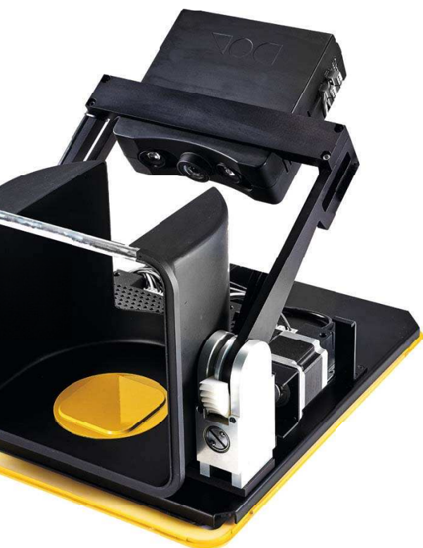
bewegliches Kamera/Licht Modul - feststehende Scanplattform
